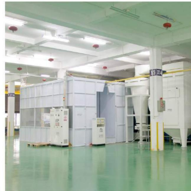
Dây chuyền sơn tĩnh điện sử dụng súng phun sơn tự động đạt tiêu chuẩn Châu Âu, hệ thống nhúng sạch qua bể định hình để tạo bề mặt tốt nhất cho sản phẩm. Hệ thống băng tải treo tự động, sơn tự động và sấy khô nhanh giúp quy trình sơn đạt năng suất cao, chất lượng tốt, giảm thiểu các lỗi đáng kể so với phương pháp thủ công, hạn chế sự phụ thuộc vào tay nghề của công nhân. Ngoài ra, hệ thống loại bỏ sơn tiết kiệm lượng sơn sử dụng và giảm tác động tiêu cực đến môi trường.
